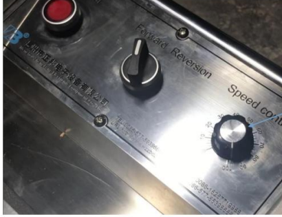
Motor hız kontrol düğmesi
